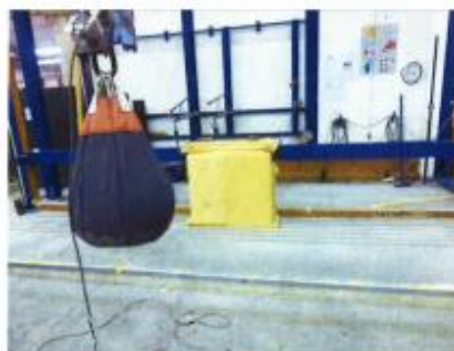
M50 / 300 Joules sur le remplissage
