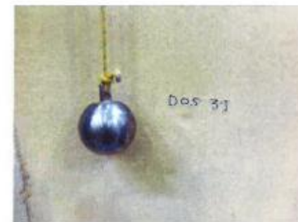
D 0.5 / 3 Joules sur le remplissage
